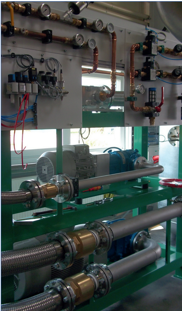
Abb. 4: Druckluftfilterprüfstand für große Prüflinge bis 3000 Nm 3 /h, Ansicht der Zwischenverdichter (Foto: IUTA e.V.)
