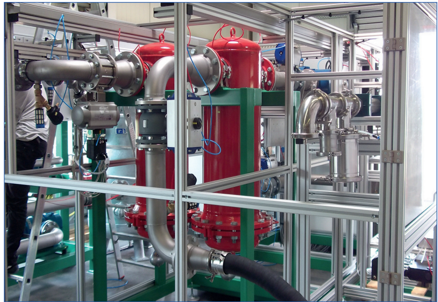
Abb. 3: Druckluftfilterprüfstand für große Prüflinge bis 3000 Nm 3 /h, Ansicht der Aufbereitungsfilter (Foto: IUTA e.V.)
