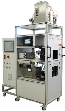
**Modularer Filterprüfstand für Fraktionsabscheidungsgradmessungen, Staubspeicherkapazität und Druckverlustkurve im Saugbetrieb. Version HF mit Temperatur und Feuchteregelung**
