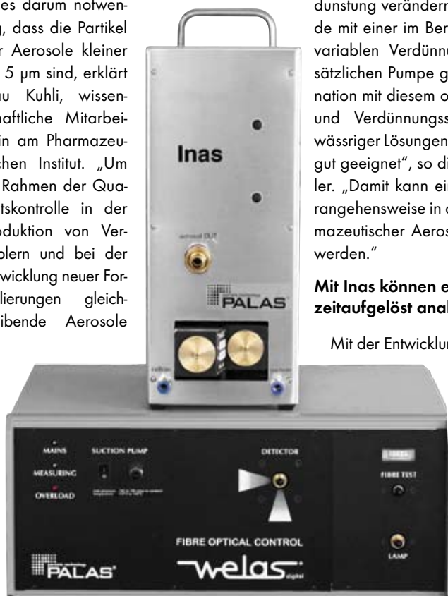
Streulichtspektrometer Inas zum Vermessen pharmazeutischer Inhalatoren
