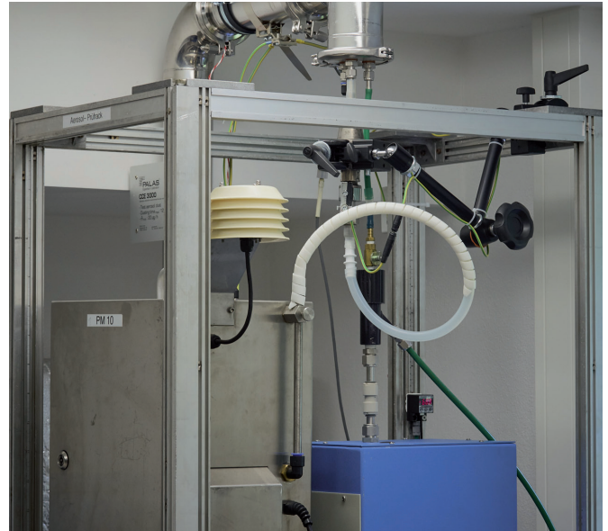
Bild 4. Isokinetische Probenahme: Referenz und Testgerät.
