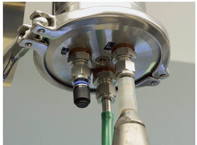
Bild 6. Detail der isokinetischen Probenentnahme.
