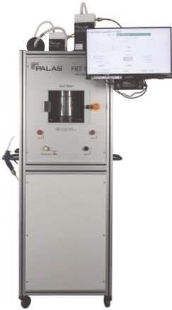
Um Qualität und Effizienz von Filterelementen zuverlässig zu bestimmen, muss neben der Gesamtpenetration auch der Energieverbrauch (Druckverlust), die Beladung und der Partikelabscheidegrad geprüft werden.
