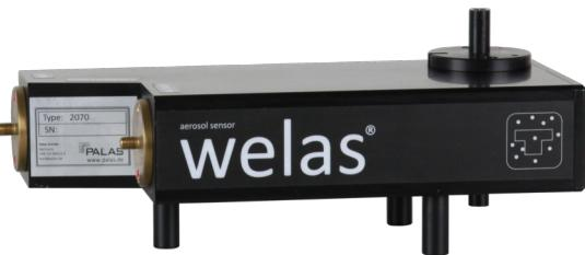
Je nach Zusammensetzung des zu messenden Aerosols, d. h. der Trägergaskomponenten und des Partikelmaterials, können Temperaturänderungen im Trägergas die Partikelgrößenverteilung und die Partikelkonzentration, z. B. durch Kondensation oder Verdampfung, signifikant beeinflussen.
