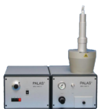
BEG 1000 B Version mit Dispergierdüse, für hohe Massenströme ca. 100 \text{ g/h} – 6 \text{ kg/h}
