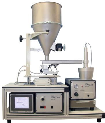
Dieses Dispergiersystem kann kontinuierlich Massenströme, z. B. 6 Kg/h, mit höchster Dosierkonstanz und -regelung mit automatischer Massenstromüberwachung erzeugen. Mit der automatischen Nachfüleinheit und der Wägeeinheit wird dieses Dispergiersystem für das kontinuierliche Dosieren über mehrere Tage sehr erfolgreich eingesetzt. Massenstromeinstellung von ca. 100 g/h – 6 kg/h bezogen auf SAE fine, A2 dust
