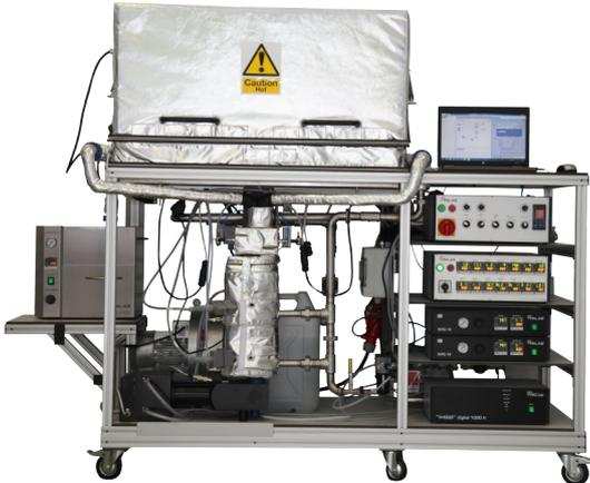
Mit dem modularen Testsystem HMT 1000 P können Ölabscheider, z. B. zum Abscheiden von Blow-By-Aerosolen in Verbrennungsmotoren oder zum Abscheiden von Ölnebeln nach Kompressoren, schnell und exakt charakterisiert und vor allem praxisnah isotherm bis 120 °C getestet werden:
