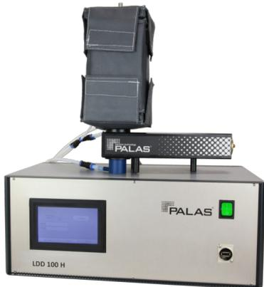
Die Verdünnung großer Tröpfchen ist besonders bei der Messung hoch konzentrierter Tröpfchenaerosole entscheidend. Da große Tröpfchen schwierig zu verdünnen sind, arbeiten Standardsysteme lediglich bis zu einer Größe von 1 - 2  $\mu\text{m}$ . Die Modellvariante LDD 100 H ist bis 150 °C beheizbar und verhindert so die Kondensation.
