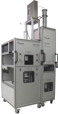
Der MFP 3000 FTD Filterprüfstand besteht aus dem Prüfstand MFP 3000 mit einer Prüffläche von  $100 \text{ cm}^2$  und dem Zusatzkanal FTD 3000 mit einer Prüffläche von  $400 \text{ cm}^2$ , die abwechselnd betrieben werden können.
