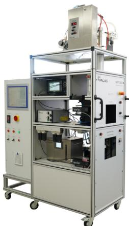
Die Version MFP 3000 G ist speziell auf die Anforderungen nach der Messprozedur nach ISO 16890 abgestimmt.
