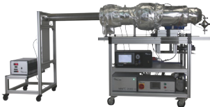
MMTC 2000 EH Edelstahlversion mit Heizung und Isolierung für Temperaturen bis 250 °C
