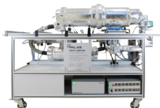
MMTC 2000 EHF Edelstahlversion mit Heizung für Temperaturen bis 250 °C und Feuchterege- lung
