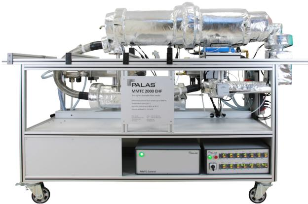
Der Filterhalter MMTC 2000 EHF ist in dieser Version aus V2A hergestellt, um einen höheren Temperaturbereich abzudecken. Die Ausrüstung mit Heizung und Isolierung ermöglicht die Filterprüfung bis zu 250 °C.
