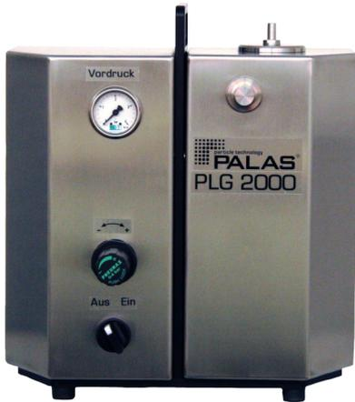
Im Gegensatz zum PLG 2000 besitzt der PLG 2000 H eine integrierte Heizung bis 100 °C. Der PLG 2000 H entspricht den Anforderungen nach ISO 16890 und EN 779 (zurückgezogen) für Ventilationsfilter. Durch die Temperierung des Öls ändert sich sowohl die Anzahlkonzentration als auch die Partikelgrößenverteilung des zu dispergierenden Materials aufgrund einer Änderung der Viskosität. Dadurch können auch Materialien dispergiert werden, die wegen ihrer Viskosität nicht kalt zu vernebeln sind.
