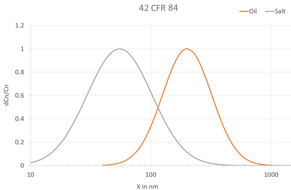
Auf Basis der Messung der Partikelpenetration über die Partikelgröße können mit dem PMFT 1000 M auch die Toleranzen in der Partikelgrößenverteilung nach EN 13274-7 als min. / max. Penetrationswert betrachtet werden. Zudem sind Vergleichswerte zu anderen Herstellern möglich (Option).
