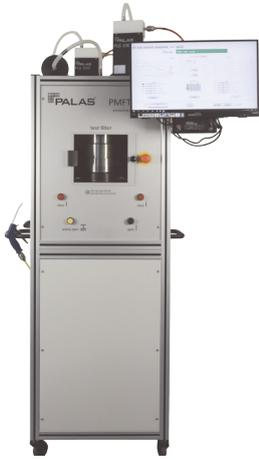
Der PMFT 4000 wurde speziell für die Anwendung in der Qualitätskontrolle von Masken, Filtermedien und Partikelfiltern entwickelt. Er testet Partikelfilter für Vollschutzmasken besser als die Normen EN 143, ISO 16900-3 und NIOSH 42 CFR 84, mit zusätzlicher exakter Analyse der Filtermaskeneffizienz für SARS-CoV-2 (Größe ca. 120 nm bis 160 nm). Darüber hinaus ist die Prüfung von Gesichtsmasken auf Basis der Normen EN 149/EN 13274-7 und GB 2626 möglich.
