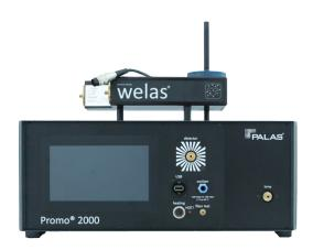
Die welas<sup>®</sup> Aerosolsensoren welas<sup>®</sup> 2070 H, HP, 2100 H, HP, 2300 H, HP und welas<sup>®</sup> 2500 H, HP sind mit einer heizbaren und ggf. druckfesten Küvette ausgerüstet, um eine isobare und isotherme Probenahme bis in das Messvolumen des Sensors sicherzustellen.
