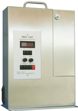
Dieses Gerät dispergiert Partikel gegen Überdruck bis 3 bar. Bei sehr geringen Vorschüben ( $< 10$  mm/h) kann die Vorschubgeschwindigkeit mittels eines Potentiometers exakt eingestellt werden. Die maximale Vorschubgeschwindigkeit beträgt 300 mm/h.
