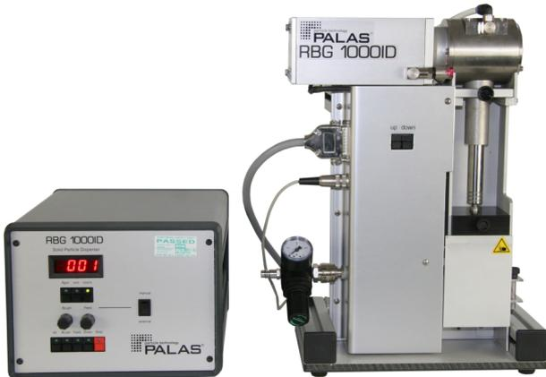
Dieses Gerät dispergiert Partikel gegen Überdruck bis 3 bar und kann außer Luft auch Stickstoff als Dispergiergas verwenden. Dispergiereinheit und elektrische Steuereinheit können bis zu 2 m voneinander getrennt aufgestellt werden.
