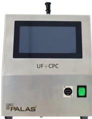
Der Palas UF-CPC 200 ist ein Butanol-basierter Nanopartikelzähler mit hoher Effizienz. Er misst die Anzahlkonzentrationen ultrafeiner Partikel (UFP) in Aerosolen. Das Modell 200 ist dabei für Konzentrationen bis  $2 \cdot 10^6$  Partikel/cm<sup>3</sup> ausgelegt. So eignet es sich speziell zur niedrig verdünnten Messung hoher Aerosolkonzentrationen aus Partikelgeneratoren, Abgas oder auch Umgebungsluft exponierter und stark belasteter Bereiche ausgelegt.
