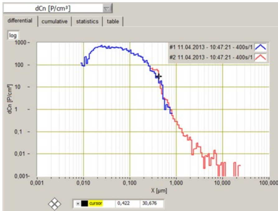
Abbildung 4: Auswertesoftware PDAnalyze. Messung einer Innenraumluftkonzentration und Darstellung der Anzahlkonzentration. Blau: Daten des U-SMPS, rot: Daten des Fidas®
