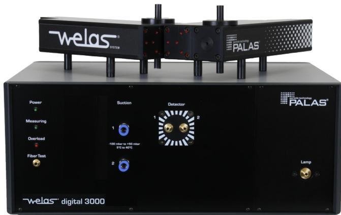
Die Aerosolsensoren welas<sup>®</sup> 2070 P, 2100 P, 2200 P, 2300 P und welas<sup>®</sup> 2500 P sind mit einer druckfesten Kuvette ausgerüstet, um eine isobare Probenahme bis in das Messvolumen des Sensors sicherzustellen.
