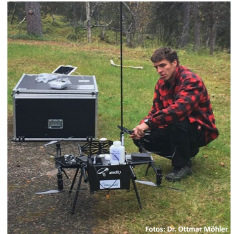
Drohnenpilot Gerd Schaufelberger mit dem Fidas® Fly 100 am HORUS-Multikopter von Airclip
