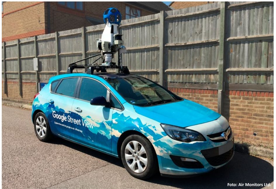
Das mit dem Fidas® Feinstaubmessgerät ausgestattete Google Street View Fahrzeug
