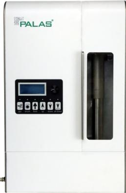
在科研、开发、质量保证以及颗粒物测量设备校准等领域，许多应用都需要使用由粉末产生的低浓度固态颗粒气溶胶。RBG 系统能够分散非粘性粉末（如矿物粉尘、活性药物成分、花粉等），其粒径范围可达 $< 200 \mu\text{m}$ ，并包含 $< 100 \text{ nm}$  的细颗粒组分。即便是黑板粉笔这类整体固体材料，也能以极高的投料均匀性实现精细分散。该投料与分散系统的独特优势在于，RBG 系统可在约 $40 \text{ mg/h}$  至约 $800 \text{ g/h}$  的宽质量流量范围内，实现很高水平的投料均匀性分散。
