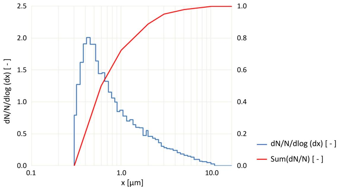
图2: 使用welas® digital 2000 测得的粒径分布
