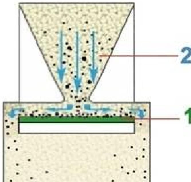
Abb. 1: Filterhalter Um das zu testende Material auf seine Partikelpenetrationseigenschaften zu prüfen, wird es in den Filterhalter eingespannt (1) und unter definierten Bedingungen mit einer Geschwindigkeit von 1 – 5 m/s angeströmt (2). Die Aerosolaufgabe und die Bestimmung der Partikelkonzentration und der Partikelgröße im Rohgas erfolgt bereits vor (2). Eine Platte hinter der Einspannung des Testmaterials (1) verhindert, dass die Luft mit dem
