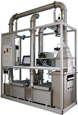
Bei diesem Prüfstandskonzept wird das zu testende Material wie in der Realität umströmt, je nach Bedarf vollständig oder optional (durch Austausch des Anström-Moduls) aus unterschiedlichen Winkeln.
