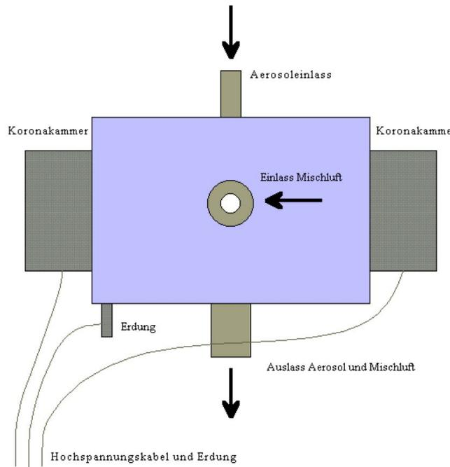
Abb. 1: Funktionsprinzip Corona-Entladung
