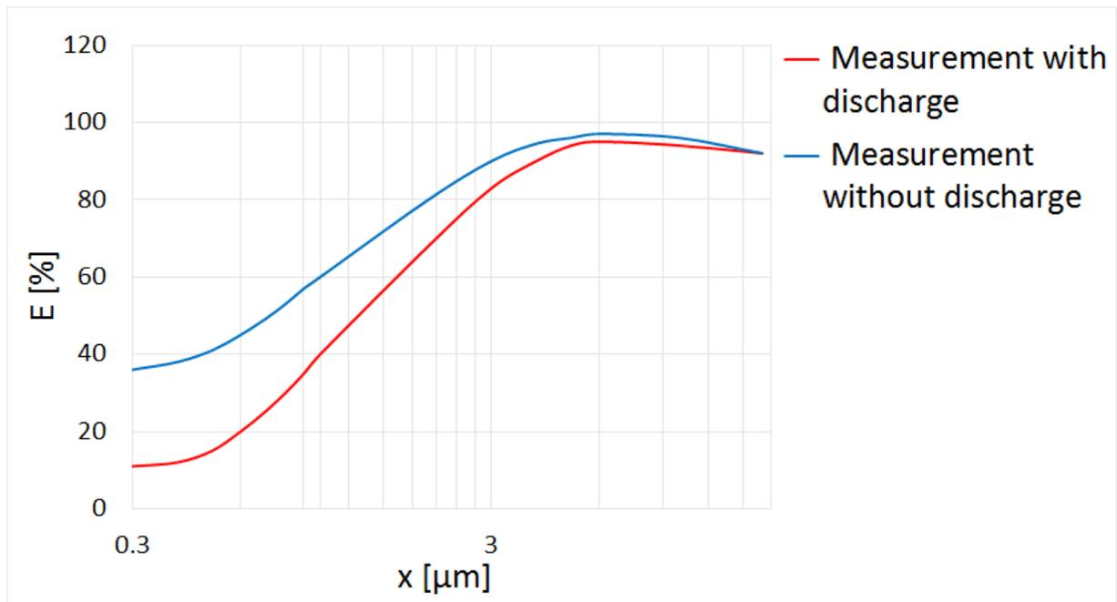
Abb. 2: Fraktionsabscheidegrad mit und ohne CD 2000
