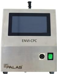
ENVI-CPC 50 是一款基于丁醇的粒子计数器，具有高检测效率，尤其适用于极小的纳米颗粒。它能监测室外空气中的超细颗粒物（UFP）浓度。50 型号设计适用于浓度高达 $10^4$  颗粒/cm<sup>3</sup> 的测量场景，这使其非常适合长期测量——单独使用或作为完整系统的一部分，用于测量UFP 的粒径分布及浓度。
