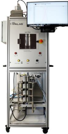
MFP 滤料测试台是一款模块化过滤测试系统，专用于平面过滤介质和小型微型滤芯。
