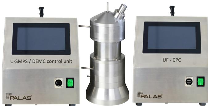
Palas U-SMPS (Universal Scanning Mobility Particle Sizers) werden zur präzisen Selektion von Partikelgröße bei gleichzeitiger Messung der Partikelkonzentration luftgetragener Partikel im Sub-Mikron-Bereich seit vielen Jahren weltweit erfolgreich eingesetzt. Sie leisten einen wichtigen Beitrag in Forschung / Entwicklung, als Messmittel zur Effizienzbestimmung von Filtermedien und -elementen und im Umweltbereich zur Konzentration- und Größenbestimmung ultrafeiner Partikel.
