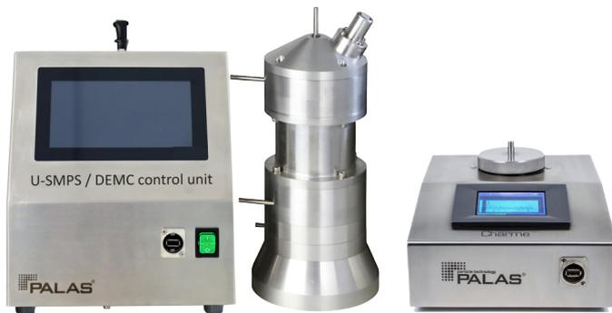
Die X-Version hat eine weiche Röntgenstrahlquelle als Neutralisierer eingebaut. Gegenüber einer radioaktiven Neutralisierung (z. B. mit Kr-85) hat dies den Vorteil, dass beim Transport des Geräts keine Auflagen zu beachten sind.
