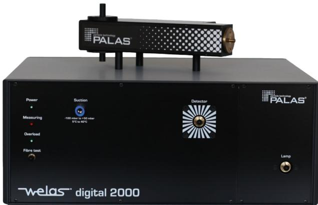
Das welas<sup>®</sup> digital 2000 ist ein flexibles, leistungsfähiges und wirtschaftliches Streulichtspektrometersystem, das die Partikelkonzentration und die Partikelgröße exakt und zuverlässig bestimmt.
