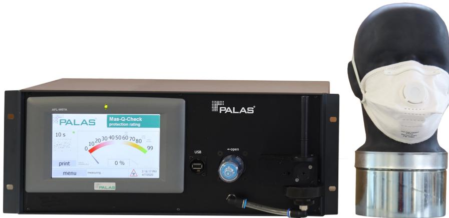
Der Mas-Q-Check wurde von Palas® entwickelt, um Schutzmasken vor der Verwendung einer schnellen, einfachen und dennoch aussagekräftigen Prüfung zu unterziehen. Es wird ein zählendes Messverfahren eingesetzt, das auch genau die Rückhaltefähigkeit bezüglich Viren oder Bakterien bestimmt. Das System kann auch zu Schulungszwecken eingesetzt werden, da es sofort die Effizienz von Schutzmasken anzeigt.
